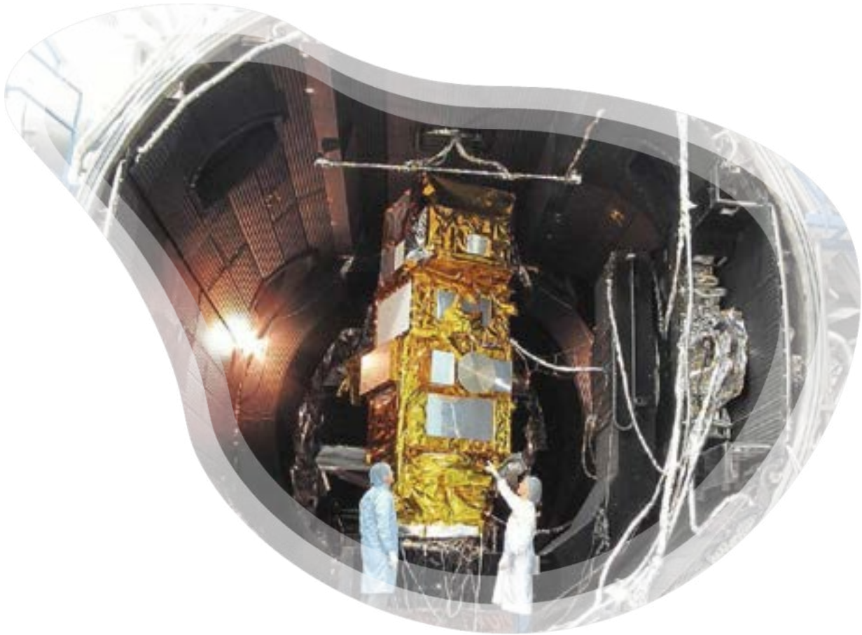
Foto de la nave espacial Sentinel-2A en la cámara de vacío térmico durante las pruebas en las instalaciones del IAGB (Créditos de imagen ESA, IAGB, 2015)
