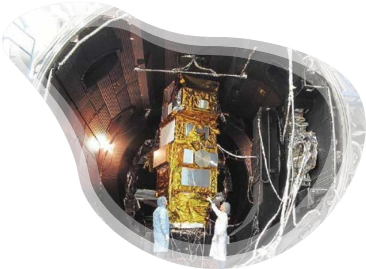
*Foto del satellite Sentinel- 2A il veicolo spaziale nella camera di test sotto vuoto termico presso le strutture dell'IAGB (Immagine di ESA, IABG, 2015)*
