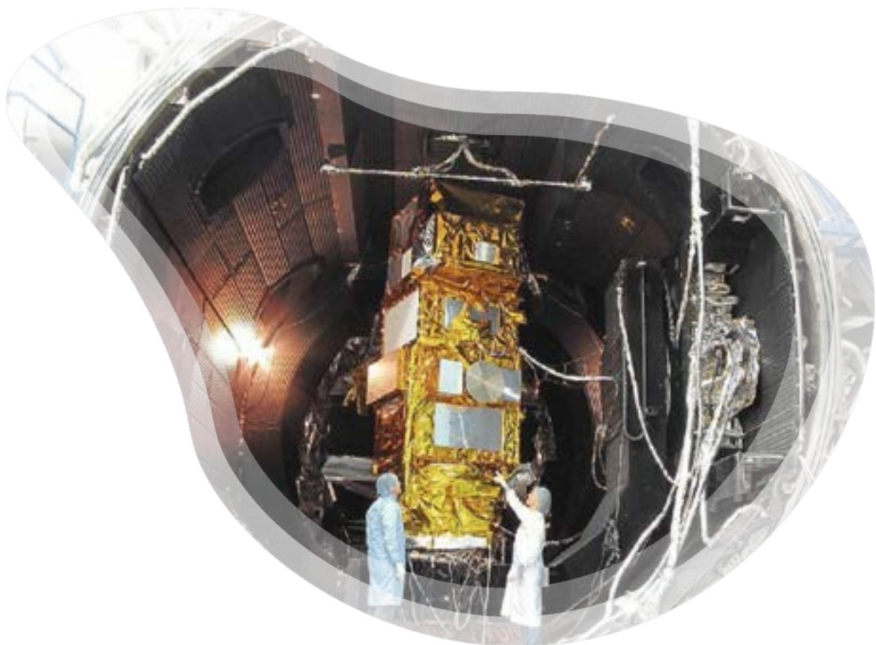
Φωτογραφία του διαστημικού σκάφους Sentinel-2A στο θάλαμο θερμικού κενού που δοκιμάζεται στις εγκαταστάσεις του IAGB (image credit ESA, IAGB, 2015)
